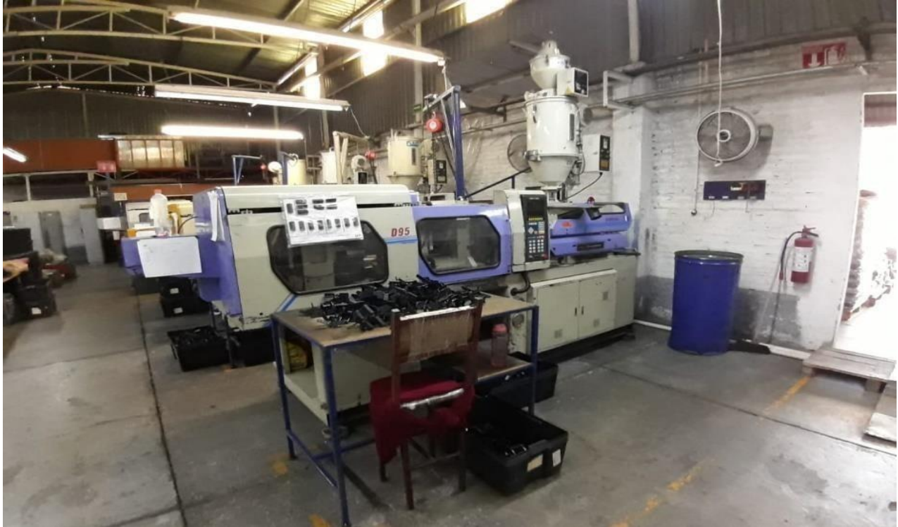
Figura 2 Maquina de inyección de plástico Mod. Lien Yu 039925. Elaboración propia 2022.
