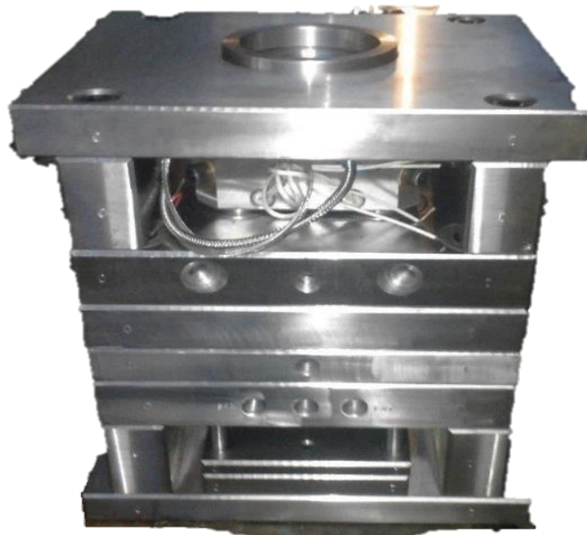
Figura 4. Molde de inyección correspondiente a el producto cuadrado de 2 “ .
